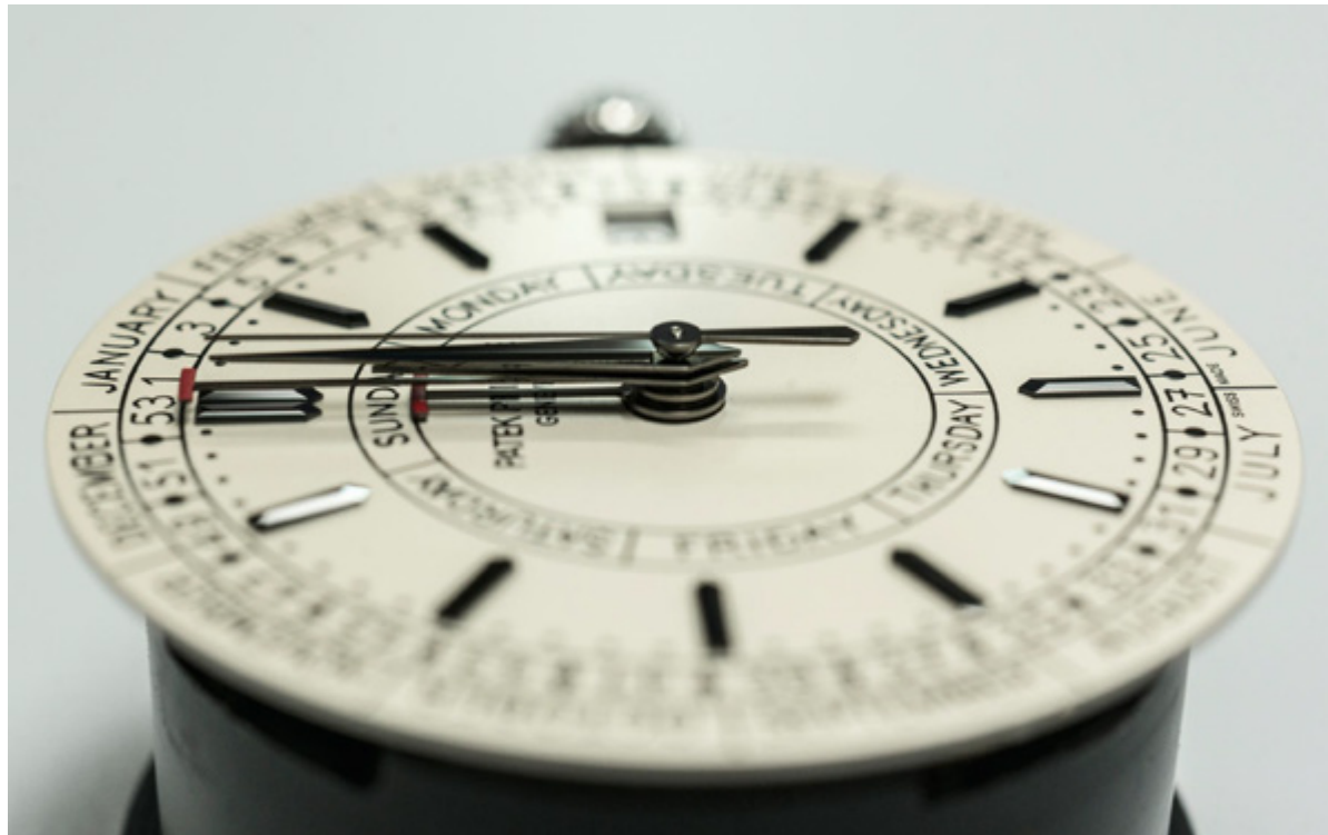
5212Aモデルの文字盤は、通常とは異なり、中央に5本の指針があり、時、分、秒、週番号、および曜日を表示する。また3時位置に日付表示窓がある。曜日と週番号の調整は、それぞれ8時位置、10時位置の調整ボタンで行う。また日付調整はリュウズで行う。
