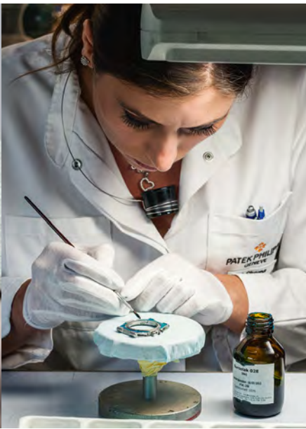
(上、右から) ノーチラスのケースは、ケース本体、ベゼル、ケースバックの3体構造である。 (下、右から) 仕上げ工程中に ケースの他の部分を保護するブルーの保護コートを用意し、リユーズ・プロテクターの間の部分を小さなグラインダーで サテン仕上げする。既に仕上げた部分を傷つけないよう最大の注意を払いながら、すべての縁にポリッシュ仕上げを施す。
