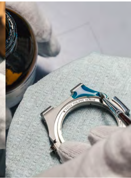
(上、右から) ノーチラスのケースは、ケース本体、ベゼル、ケースバックの3体構造である。 (下、右から) 仕上げ工程中に ケースの他の部分を保護するブルーの保護コートを用意し、リユーズ・プロテクターの間の部分を小さなグラインダーで サテン仕上げする。既に仕上げた部分を傷つけないよう最大の注意を払いながら、すべての縁にポリッシュ仕上げを施す。
